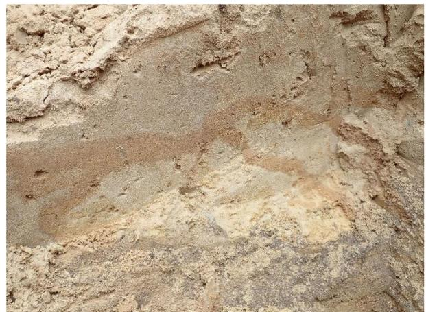
Fig. 6: Lamellen aus tonigem Sand (BDS19-86: Bbt1, 65-70 cm)
