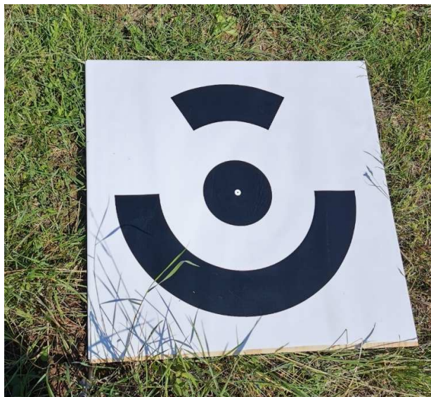
Abbildung 4: Panele zur automatisierten Erkennung und Korrektur der Lagegenauigkeit
