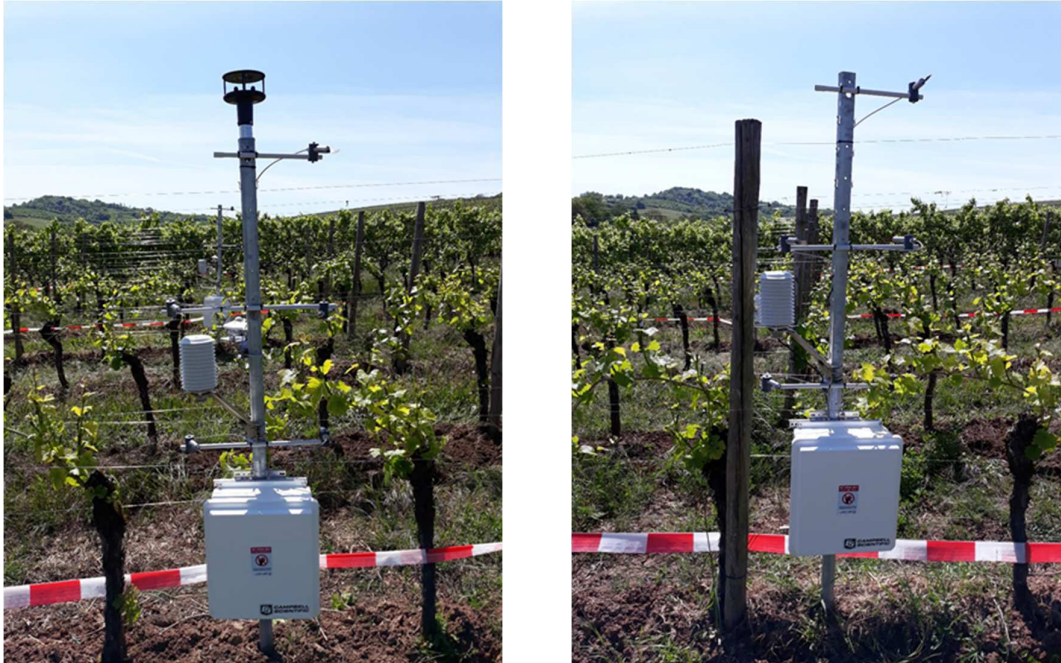
Abbildung 7: Voll ausgestattete Station (links) mit zusätzlichem Globalstrahlungsgeber und 2D Wind Sonic, sowie einfache Station (rechts) zur Erfassung der Blattnässe, Lufttemperatur und relativen Feuchte im Bestand.
