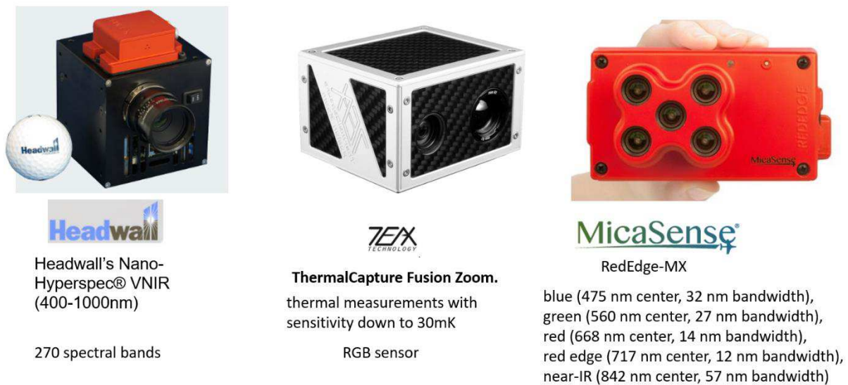
Abbildung 4: Die drei eingesetzten Kameras im Vergleich. Links die Headwall Nano, Hyperspektralkamera, Mitte, die Teax Thermal Capture Fusion Zoom, Thermalkamera und rechts, die fünf-Band Kamera Micasense RedEdge
