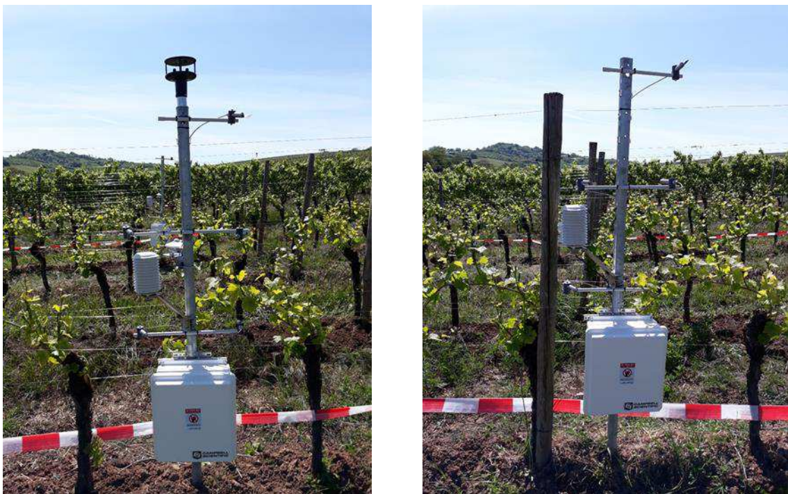
Abbildung 9: Voll ausgestattete Station (links) mit zusätzlichem Globalstrahlungsgeber und 2D Wind Sonic, sowie einfache Station (rechts) zur Erfassung der Blattnässe, Lufttemperatur und relativen Feuchte im Bestand.
