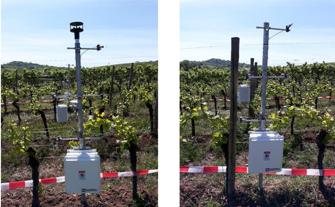
**Abbildung 2.3.6.2: Voll ausgestattete Station (links) mit zusätzlichem Globalstrahlungsgeber und 2D Wind Sonic, sowie einfache Station (rechts) zur Erfassung der Blattnässe, Lufttemperatur und relativen Feuchte im Bestand.**
