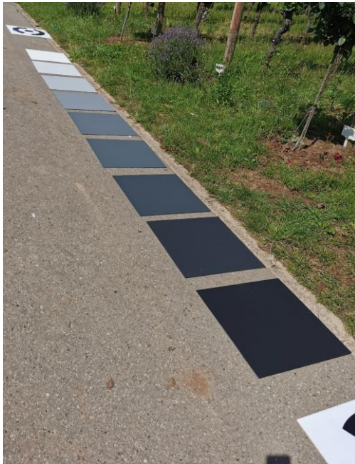
Abbildung 2.3.4.2: Referenzpaneele zur Erhebung von Referenzdaten für die Atmosphärenkorrektur
