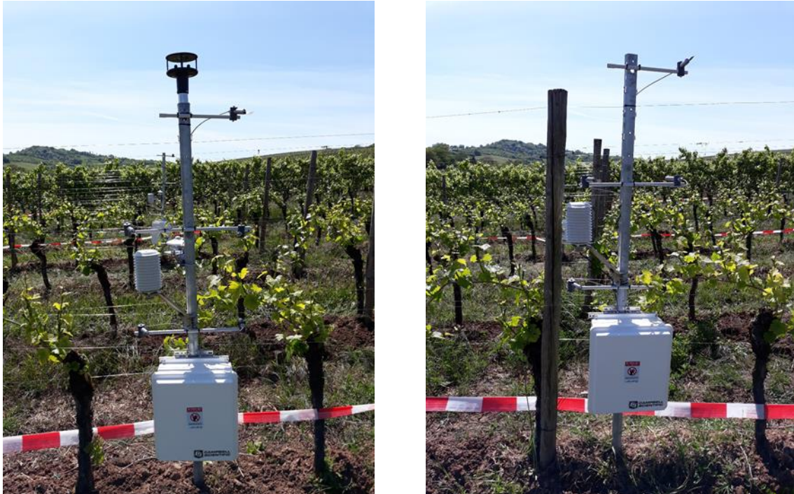
Abbildung 2.3.6.2: Voll ausgestattete Station (links) mit zusätzlichem Globalstrahlungsgeber und 2D Wind Sonic, sowie einfache Station (rechts) zur Erfassung der Blattnässe, Lufttemperatur und relativen Feuchte im Bestand.
