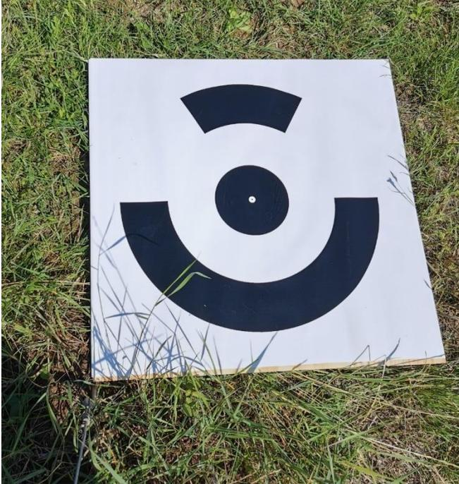
Abbildung 2.3.4.3: Panele zur automatisierten Erkennung und Korrektur der Lagegenauigkeit
