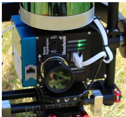
Headwall Nano Hyperspec 400 nm – 1000 nm, 272 Kanäle
