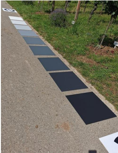
**Abbildung 2.3.4.2: Referenzpanele zur Erhebung von Referenzdaten für die Atmosphärenkorrektur**
