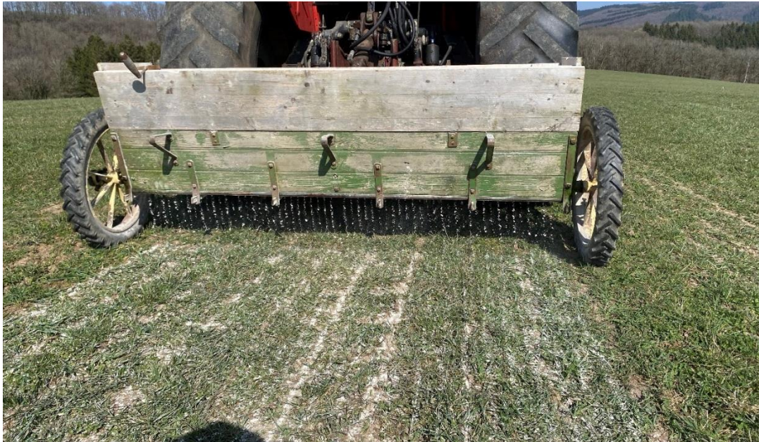
Abbildung 2: Hintere Ansicht des Kastenstreuers bei der Ausbringung des Kalkes.
