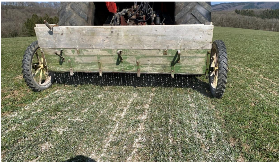
Abbildung 3: Hintere Ansicht des Kastenstreuers bei der Ausbringung des Kalkes.
