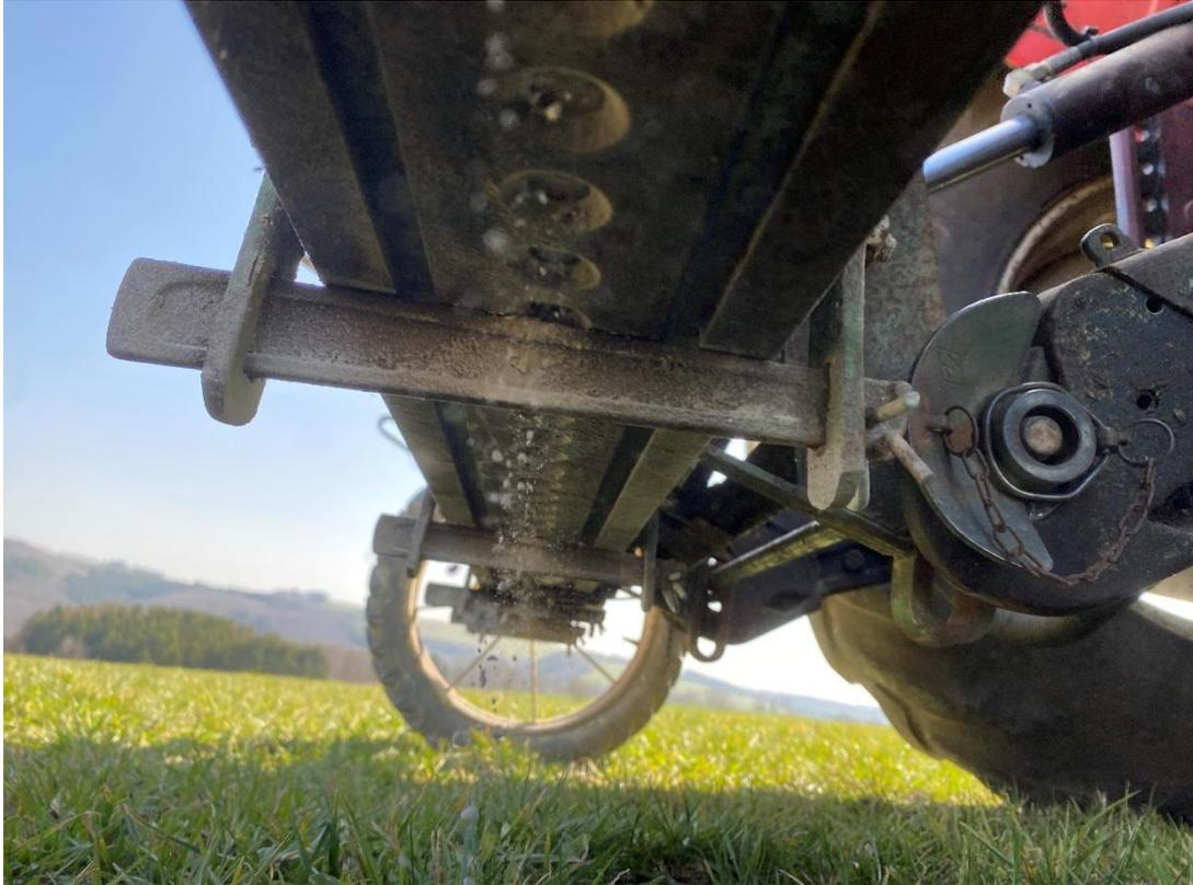
Abbildung 2: Untere Ansicht des Kastenstreuers mit Lochscheibe.
