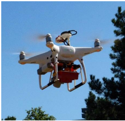
Abbildung 15: UAV-setup: DJI Phantom 4 Pro (links) mit Micasense RedEdge-M camera (mitte) und Spektrale Eigenschaften der Micasense RedEdge-M-Kamera (rechts).
