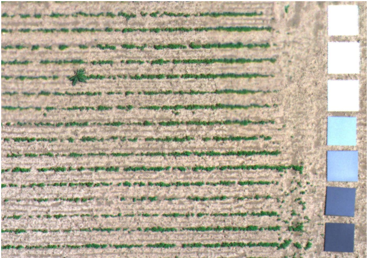
Abbildung 14: Detailaufnahme des Versuchsfeldes inkl. des Referenz-Graukeils zur Radiometrischen Korrektur der Daten.
