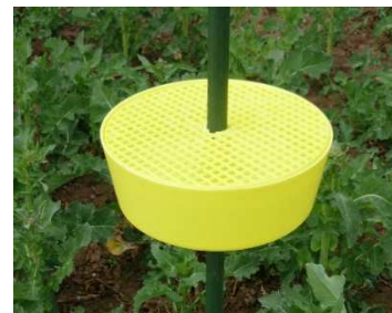
Bild 1: Höhenverstellbare Gelbschale mit Gitterauflage. Das Gitter schließt unerwünschten Beifang aus, z.B. Hummeln.
