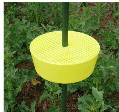
**Bild 1:** Höhenverstellbare Gelbschale mit Gitterauflage. Das Gitter schließt unerwünschten Beifang aus, z.B. Honigbienen und Hummeln.
