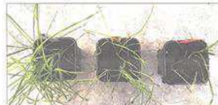
Abbildung 2: Nachaufspritz-Test. Links: keine Herbizidwirkung, Mitte: geringe Herbizidwirkung, rechts: starke Herbizidwirkung
