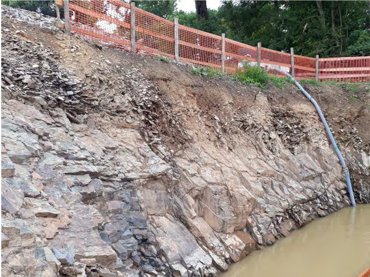
Figure 20 : Profil de sol Gbbfi 2 où l'on peut distinguer la couche de schiste imperméable située entre 2 et 5 m de profondeur. On remarque la charge caillouteuse s'intensifie et s'organise avec la profondeur.
