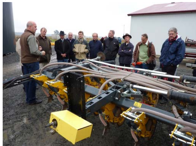
Abb. 4: Die auf dem Gut Norups Gard entwickelte Kombimaschine für Säen, mechanische Unkrautbekämpfung und Präzisionsspritzen
