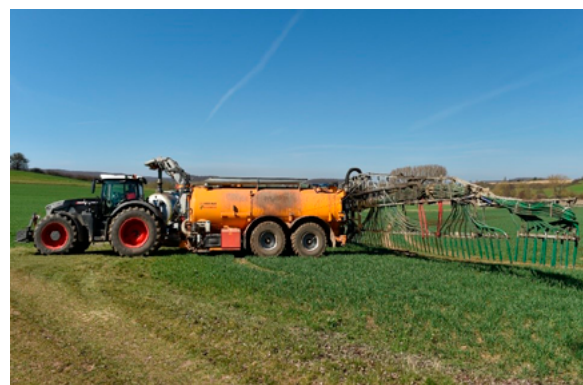
Schleppschlauchverteiler (Quelle: Landwirtschaftskammer Nordrhein-Westfalen)
