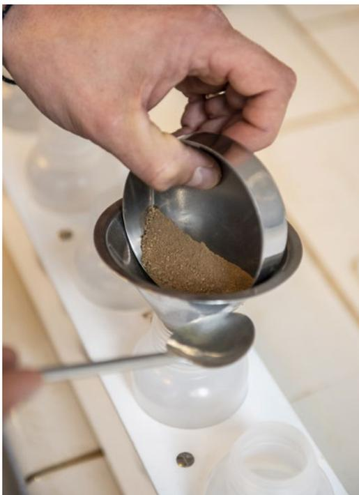
Figure 5. Prise d'échantillon de sol séché et tamisé (photo A. Dehez)
