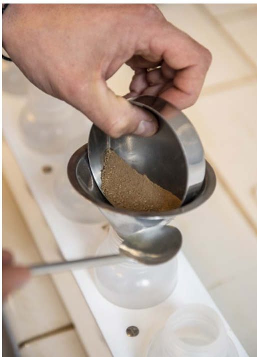
Figure 5. Prise d'échantillon de sol séché et tamisé (photo A. Dehez)
