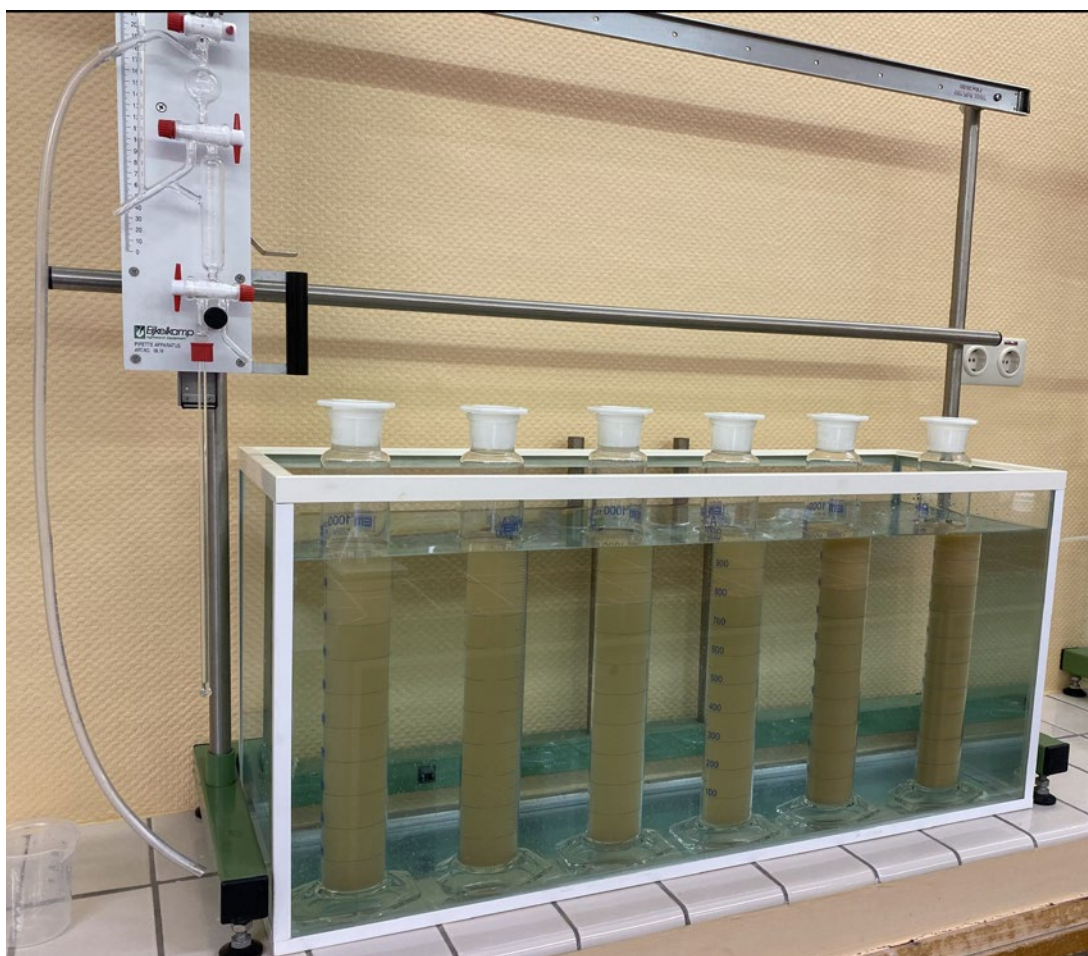
Figure 7. Eijkelkamp Pipette Apparatus et les colonnes de sédimentation dans un bain à eau à température constante
