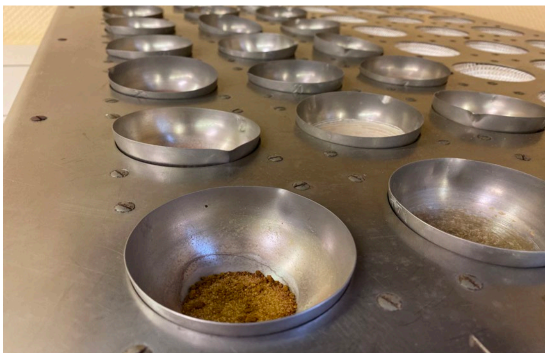
Figure 8. Fraction sableuse en cupule de nickel séchée sur plaque chauffante à 250 °C
