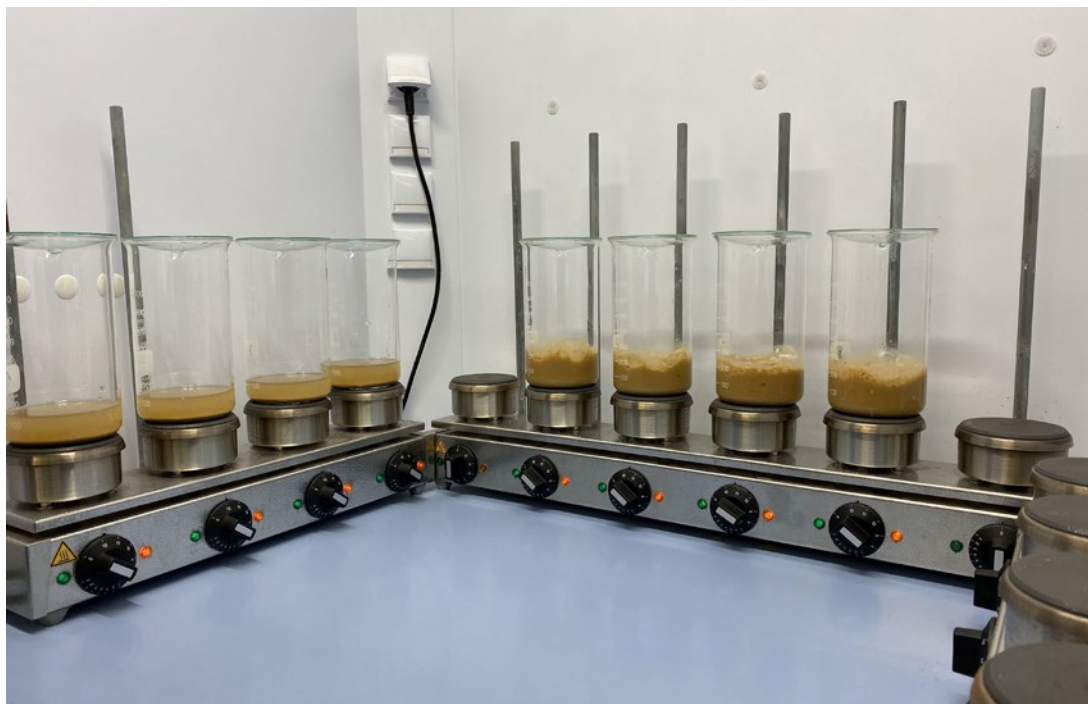
Figure 6. Attaque au peroxyde d'hydrogène à chaud sous hotte
