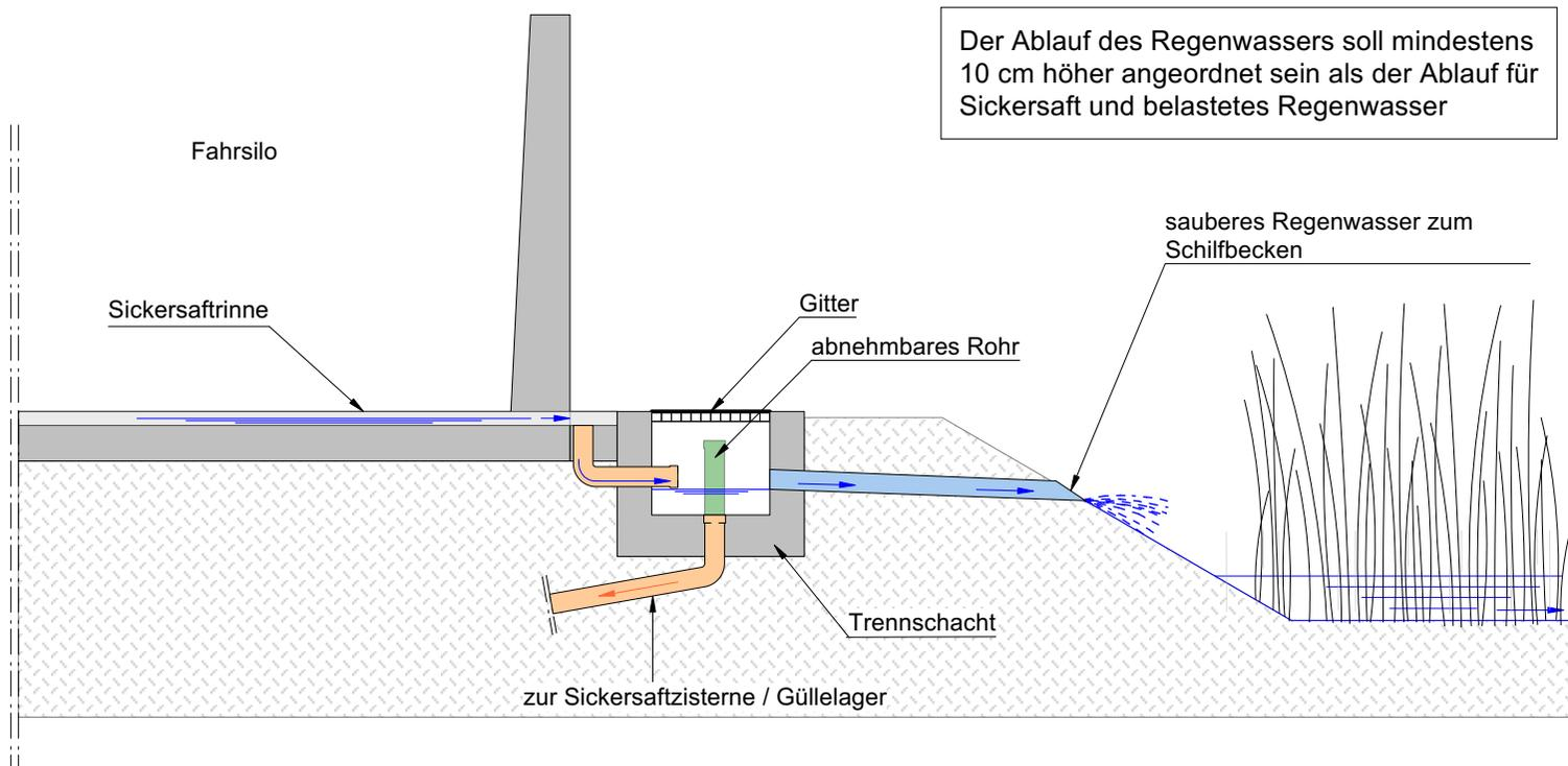
Der Ablauf des Regenwassers soll mindestens 10 cm höher angeordnet sein als der Ablauf für Sickersaft und belastetes Regenwasser
